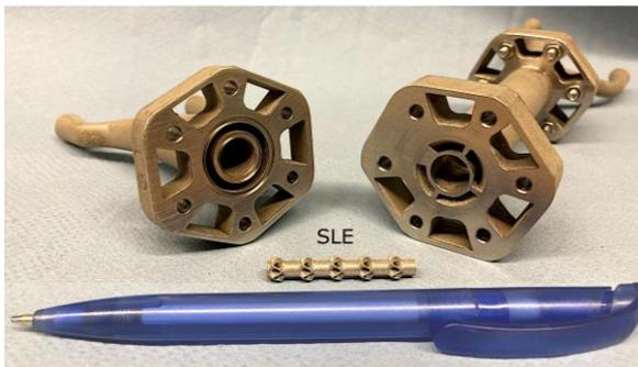
Abbildung 2: Foto des additiv gefertigten, geöffneten Reaktors und eines SLEs im Vordergrund. Der Reaktor wurde mittels selektiven Laserschmelzens aus Edelstahlpulver (SS 316L) hergestellt (ReaLizer SLM125, Germany).
