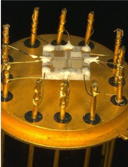
Abbildung 1: Sensorsystem mit 4-fach Sensorarray
